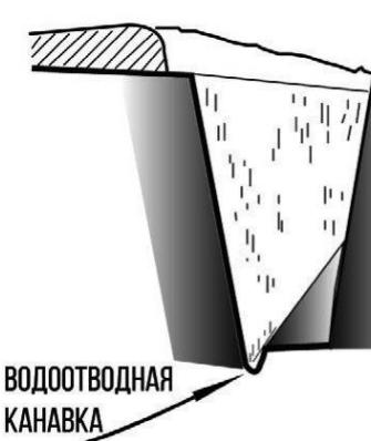
Рис. 2. Водоотводная канавка на дне траншеи
