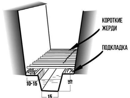
Рис. 3. Перекрытая водоотводная канава на дне траншеи
