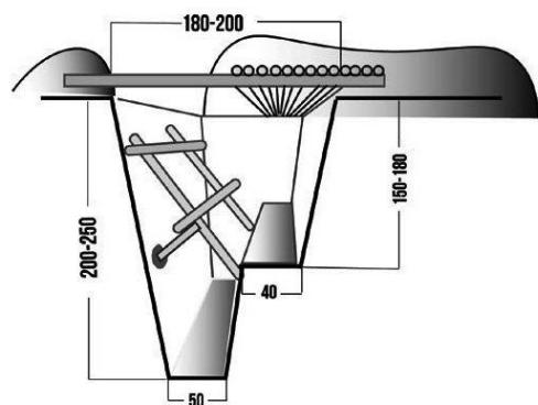
Рис. 5. Отхожее место в траншее оборудованное жердями
