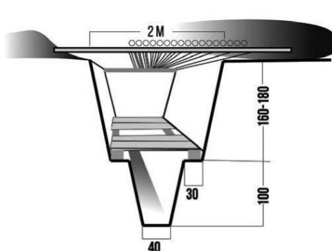
Рис. 4. Отхожее место в траншее, оборудованное поддоном
