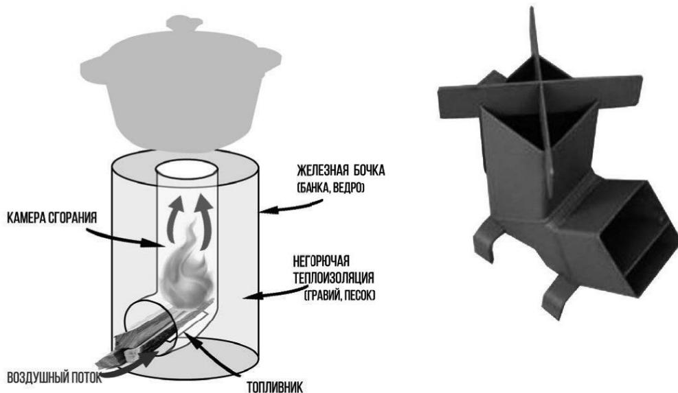
Рис. 9. Ракетная печь из двух консервных банок (водосточной трубы) различного диаметра
