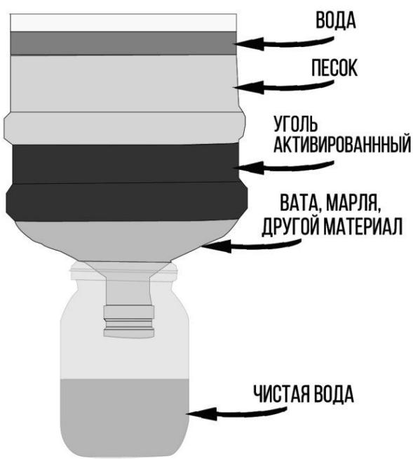
Рис. 11. Фильтр для очистки воды
